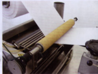
Die com2C-Testmaschine in Vlotho: Vor der Markteinführung hat com2C das neuentwickelte Coat IJ32 im eigenen Haus auf Herz und Nieren geprüft. Dazu durchlief das Textil im Tauchbeschichtungsverfahren (Foulard-Technik) die Coating-Maschine.
