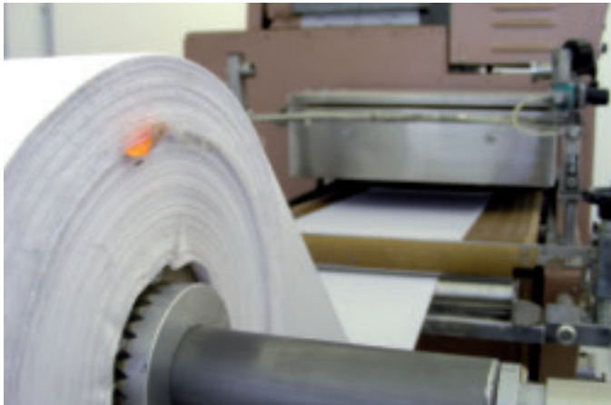
Abb. 3 & 4: Die com2C-Testmaschine in Vlotho: Bevor es zu den Textilherstellern und -veredlern ging, hat com2C das neuentwickelte Coat IJ32 im eigenen Haus auf Herz und Nieren geprüft. Dazu durchlief das Textil im Tauchbeschichtungsverfahren (Fouillard-Technik) die Coating-Maschine.
